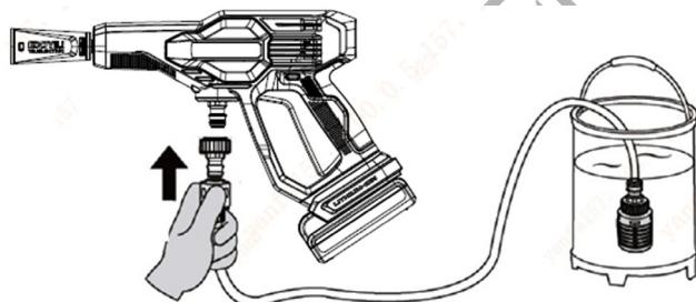
Συνδέστε τον εύκαμπτο σωλήνα αναρρόφησης (θηλυκό σύνδεσμο) στην είσοδο νερού του πλυστικού και, στη συνέχεια, βιδώστε τον εύκαμπτο σωλήνα αναρρόφησης (αρσενικό άκρο) στις ανοιχτές δεξαμενές.
