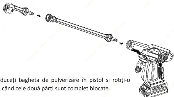
Introduceți bagheta de pulverizare în pistol și roțiți-o până când cele două părți sunt complet blocate.
