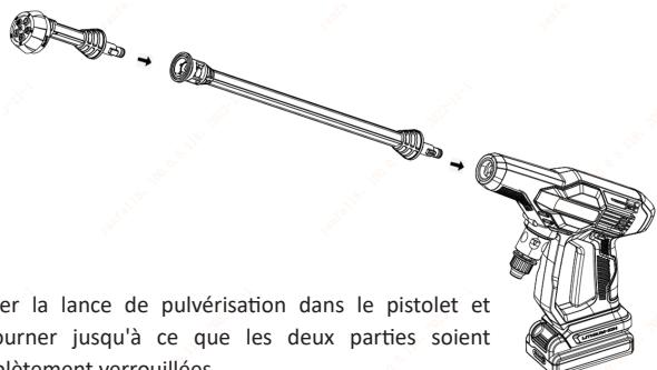
Insérer la lance de pulvérisation dans le pistolet et la tourner jusqu'à ce que les deux parties soient complètement verrouillées.
