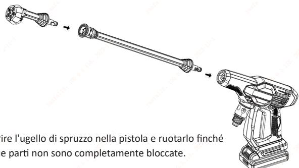
Inserire l'ugello di spruzzo nella pistola e ruotarlo finché le due parti non sono completamente bloccate.
