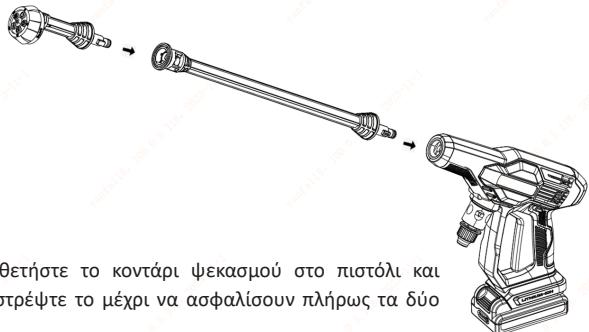
Τοποθετήστε το κοντάρι ψεκασμού στο πιστόλι και περιστρέψτε το μέχρι να ασφαλίσουν πλήρως τα δύο μέρη.
